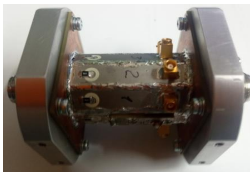
Рисунок 5. – Конструкция коаксиального направленного ответвителя
