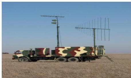
1-сурет. – «CICADA-C» мобильді кедергі станциясы
