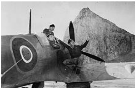
Рисунок 3. – Проволочная антенна системы идентификации, соединяющаяся с фюзеляжем в центре опознавательного знака Королевских ВВС. Антенны размещены по обеим сторонам фюзеляжа. Вес антенн 18 кг
