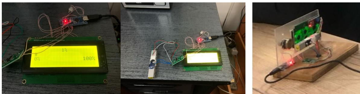
6-сурет. – Графен негізіндегі тензометрлі сенсордың жалпы көрінісі
