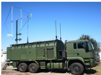
3-сурет. – «Рубин» мобильді кедергі станциясы
