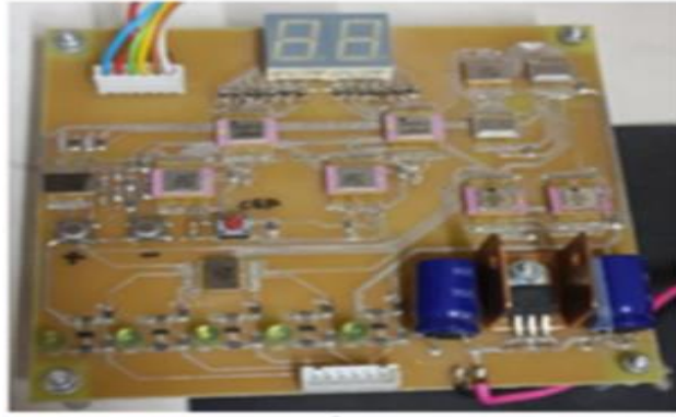
Рисунок 3. – Плата управления фазовращателем и аттенюатором
